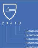
Resistencia al corte TDM Resistencia a la perforación Resistencia al rasgado Resistencia al corte por cuchilla
